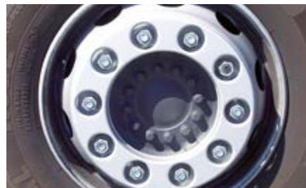
一道锌片涂层系统由一层底涂和一层面涂组成。面涂能实现可调摩擦系数，这是轮毂螺栓与螺母涂层的关键所在。
