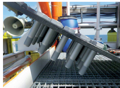
将涂覆有各种涂层的M24螺栓试样移至波罗的海上的FINO平台
