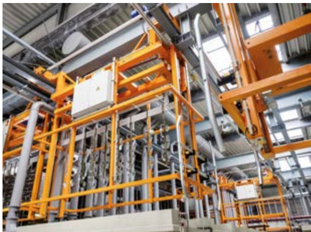
示例1: 高性能机架镀锌能够实现高生产力的大型零件涂层施工
